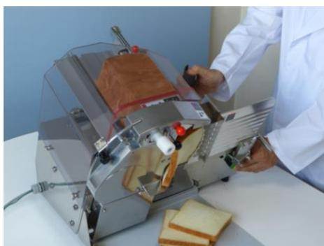
2つのボタンを両手で操作している間のみ、刃が回転する(片手をボタンから離れたときは刃が急停止)
